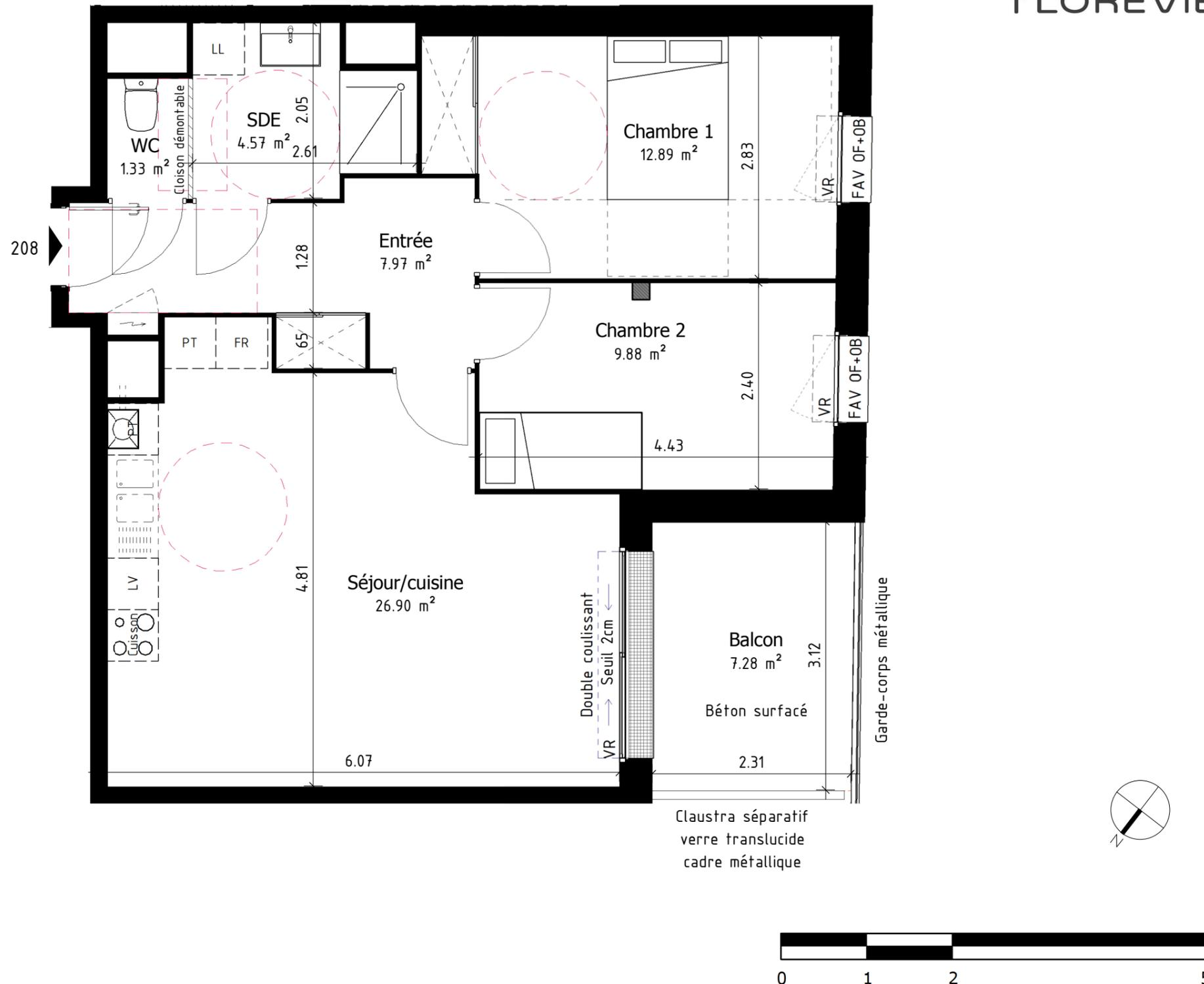
OF : Ouvrant à la Française - OB Ouvrant Oscillo Battant - PF : Porte Fenêtre - FE : Fenêtre sur allège pleine - FAV : Fenêtre sur Allège Vitrée - Fixe : Châssis Fixe - VR : Volet Roulant
